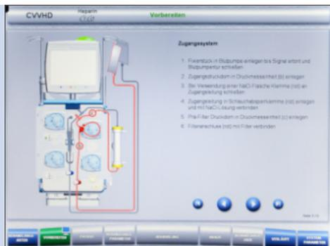
18. Pre-Filter Druckdom in Druckmesseinheit (c, Maschine oben) einlegen.
